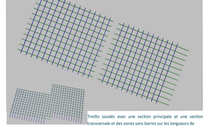
recouvrements. Remplace les treillis soudés standard ADETS avec une fabrication aux longueurs souhaitées évitant découpage et chutes, et l'absence de barres sur les zones de recouvrements évitant la mise en œuvre inutile de barres doublées et les surépaisseurs .
