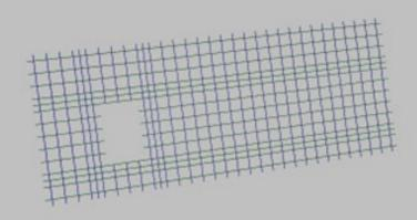
Treillis soudés avec une section principale et une section transversale ave une ou plusieurs zone sans barres pour vos réservations.
